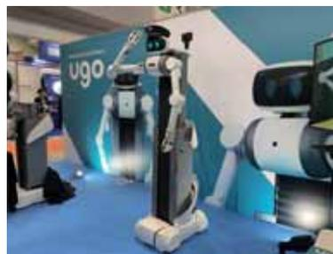
遠隔操作ロボット「ugo」。遠隔操作で移動できるだけでなく、ロボットアームで繊細な手作業も可能。AIによって作業を学習することもできる。遠隔地の建設現場で「現場事務所と本社間で指示のやり取りなどができないか」と導入を検討する会社もあった。
