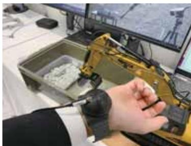
振動センサーを建機のアームに取り付け、受信機を操縦者の手に付けることで、細かな振動などを操縦者が感じることが出来る。特に遠隔操作の際に、繊細な作業が可能になる。
