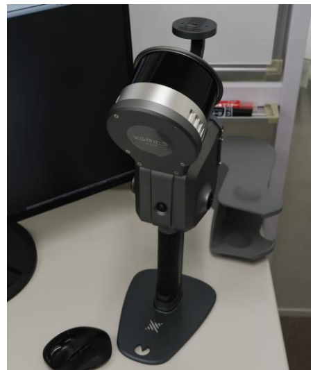
ニコン・トリンブル社のSX10 トータルステーションとしても3Dレーザスキャナーとしても使える優れたもの。これまでだいぶ活躍してくれたそうです。
