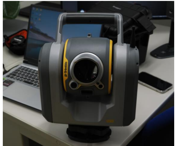
ニコン・トリンブル社のSX10 トータルステーションとしても3Dレーザスキャナーとしても使える優れたもの。これまでだいぶ活躍してくれたそうです。
