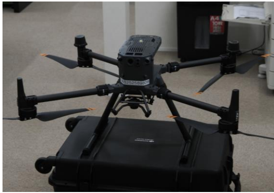
DJI社のフラッグシップドローン 「Matrice 350 RTK」 RTK測位を行いながらの高精度な飛行、計測が可能です。
